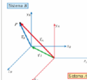
Figura 6 Vettori posizione relativi a due sistemi di riferimento in moto a velocità costante.
